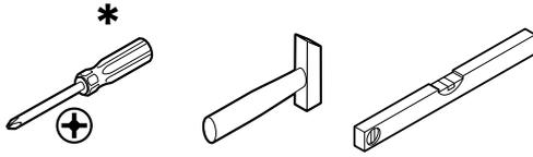
**\*** **VORSICHT:** Bei Verwendung eines Akkuschraubers (nicht empfohlen) möglichst niedrige Drehmomentstufe wählen!
